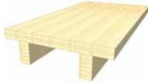
Eine Materialersparnis und direkt über KLH® beziehbare Lösung wären Rippelemente. Die Querschnittshöhe wird zwangsweise etwas höher ausfallen, der Zwischenraum kann jedoch, je nach Rippensituation, bereits für den Schallschutz oder als Installationsraum genutzt werden.
